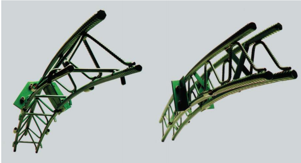
Mynd 7.7 Þríhyrnd (t.v.) og ferhyrnd (t.h.) grind sprautusteypuboga (Jörimann, 2013).
